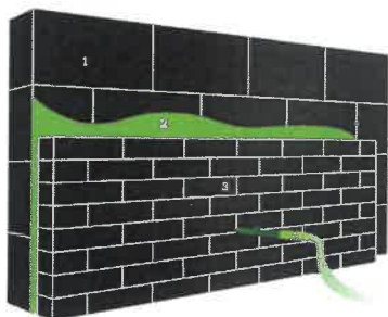
1. Dragende muur | 2. Ingeblazen isolatie | 3. Gevelsteen / gevelbekleding
