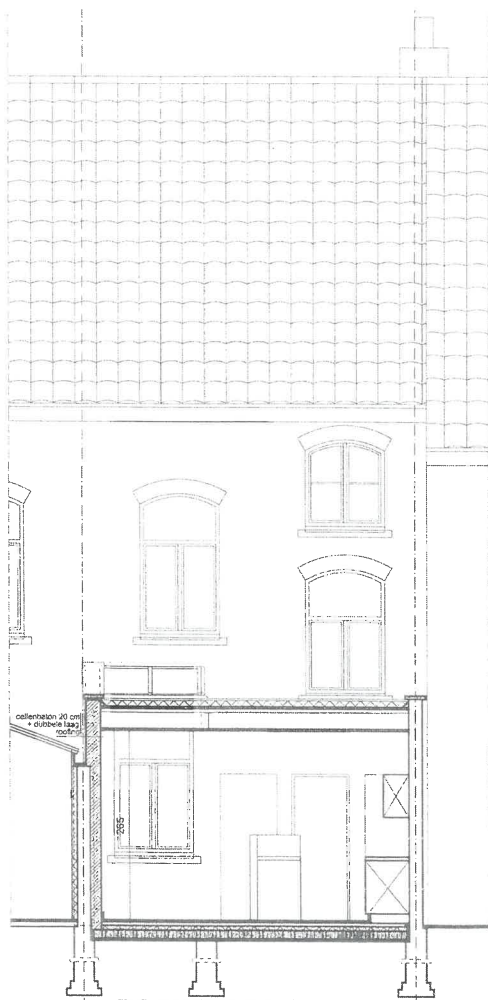
DOORSNEDE (nieuw) (over scheimuur achterbouw)
