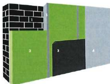
1. Buitengevel | 2. Isolatie | 3. Dampschermb | 4. Binnenafwerking | 5. Stijl- en regelwerk (optioneel)
