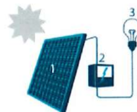
1. Zonnepaneel | 2. Omvormer 3. Elektrische toestellen
