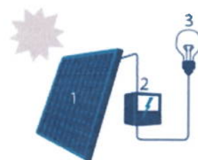
1. Zonnepaneel | 2. Omvormer 3. Elektrische toestellen
