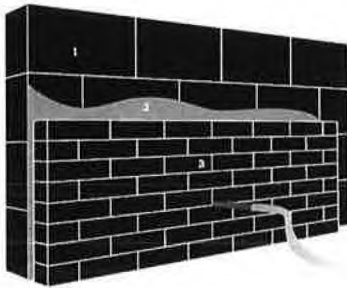
1. Dragende muur | 2. Ingeblazen isolatie | 3. Gevelsteen / gevelbekleding
