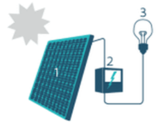
1. Zonnepaneel | 2. Omvormer | 3. Elektrische toestellen
