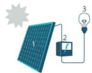
1. Zonnepaneel | 2. Omvormer | 3. Elektrische toestellen
