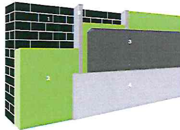
1. Buitenmuur | 2. Isolatie | 3. Vochtschermbekleding | 4. Afwerkingslaag | 5. Stijl- en regelwerk (optioneel)
