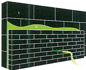
1. Dragende muur | 2. Ingeblazen isolatie | 3. Gevelsteen / gevelbekleding
