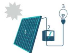
1. Zonnepaneel | 2. Omvormer | 3. Elektrische toestellen
