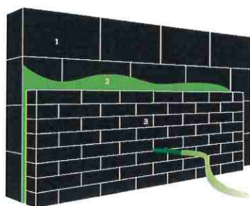
1. Dragende muur | 2. Ingeblazen isolatie | 3. Gevelsteen / gevelbekleding
