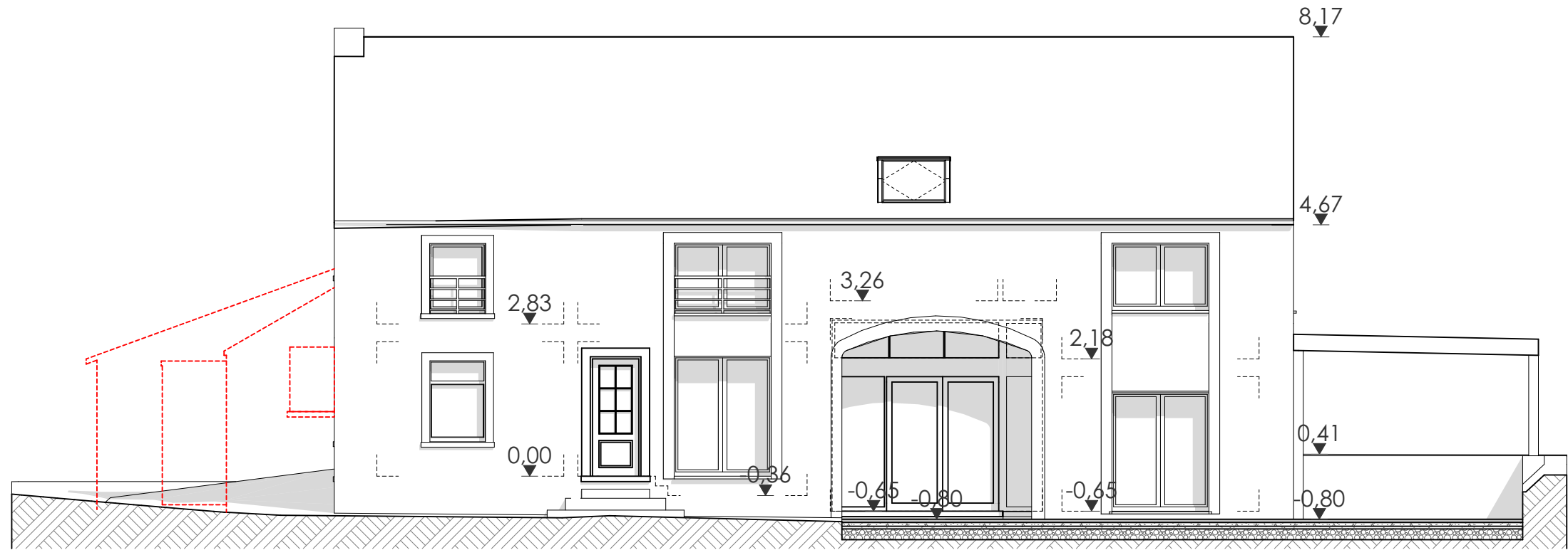
Elévation avant éch. : 1:100
