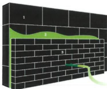
1. Dragende muur | 2. Ingeblazen isolatie | 3. Gevelsteen / gevelbekleding
