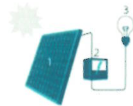
Figuur 13: Zonnepanelen met inverter
