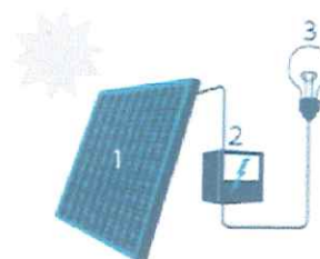
1. Zonnepaneel | 2. Omvormer | 3. Elektrische toestellen
