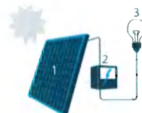
1 Zonnepaneel | 2 Omvormer | 3 Elektrische toestellen
