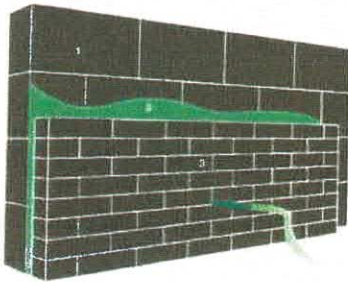
1. Dragende muur | 2. Ingeblazen isolatie | 3. Gevelsteen / gevelbekleding
