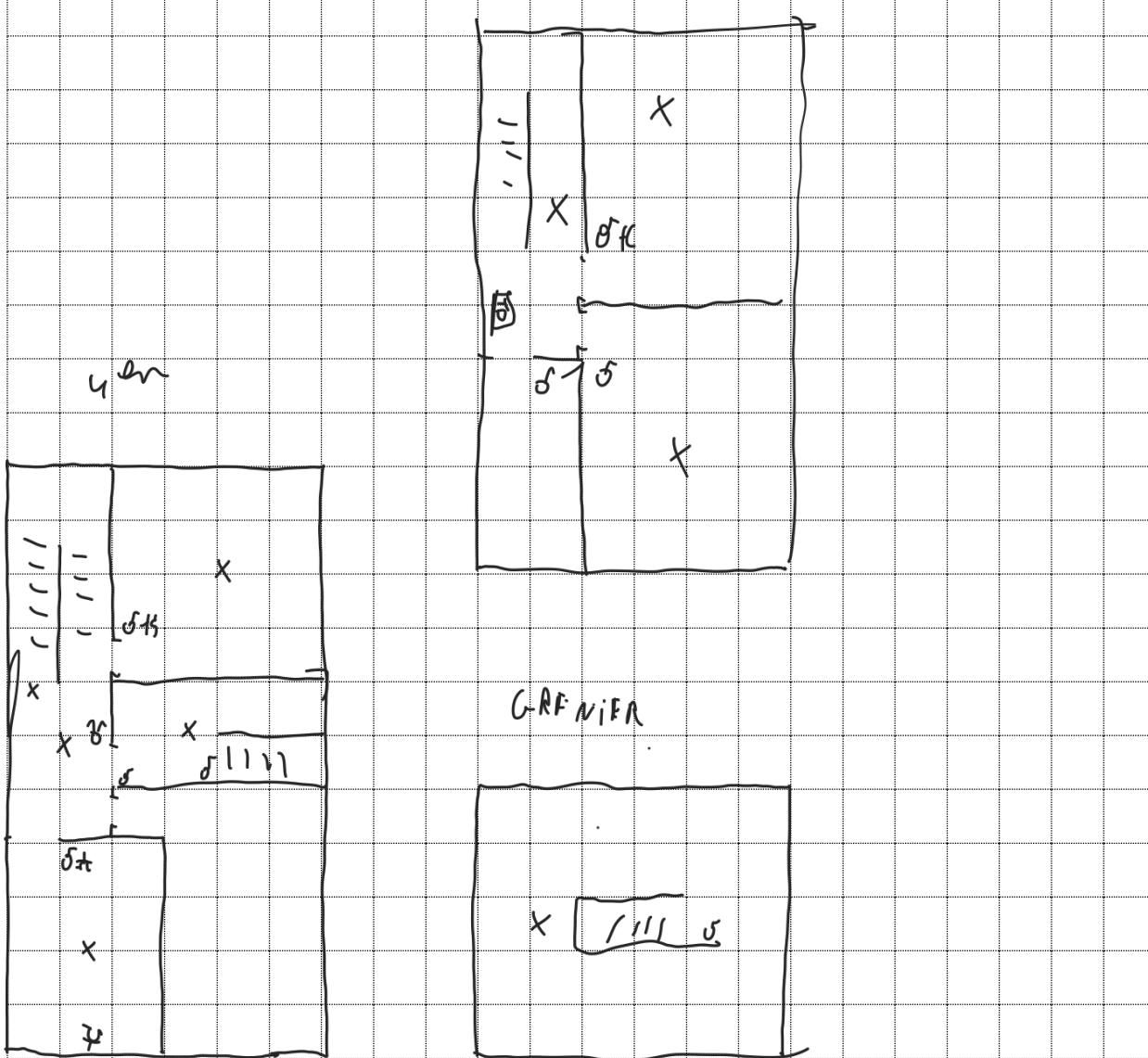
Ce croquis n'a pour but que de fixer, au moment du contrôle, l'étendue de l'installation ou de la partie de l'installation initiée avant octobre 1981. Il ne peut en aucun cas remplacer le schéma unifilaire ou le plan de position dont l'absence au moment du contrôle constitue une infraction.
