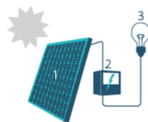
1. Zonnepaneel | 2. Omvormer | 3. Elektrische toestellen
