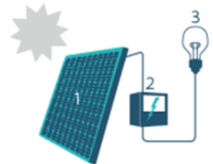
1. Zonnepaneel | 2. Omvormer | 3. Elektrische toestellen
