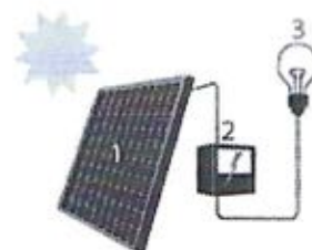
1 Zonnepaneel | 2 Omvormer | 3 Elektrische toestellen
