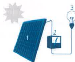
1. Zonnepaneel | 2. Omvormer 3. Elektrische toestellen
