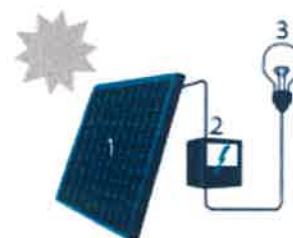
1. Zonnepaneel | 2. Omvormer | 3. Elektrische toestellen
