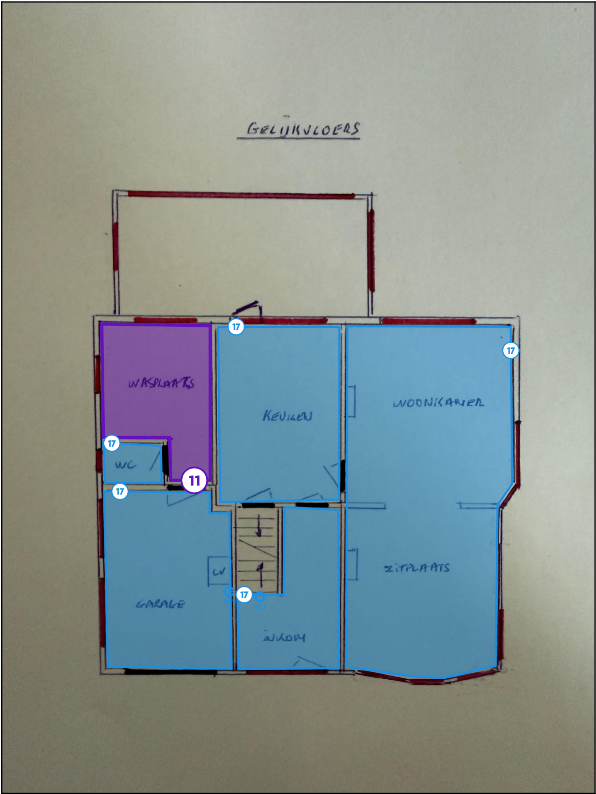
Legende van plan 1.3: gelijkvloers (pleisterwerk plafonds)
