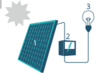
1. Zonnepaneel | 2. Omvormer | 3. Elektrische toestellen
