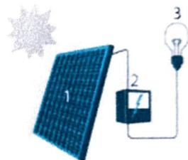
1. Zonnepaneel 2. Omvormer 3. Elektrische aansluiting
