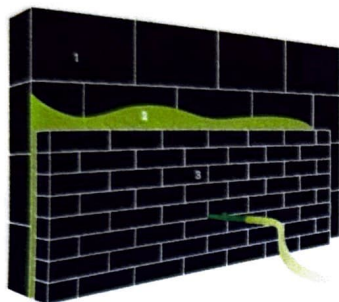
1. Dragende muur | 2. Ingeblazen isolatie | 3. Gevelsteen / gevelbekleding
