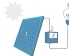
1. Zonnepaneel | 2. Omvormer 3. Elektrische toestellen
