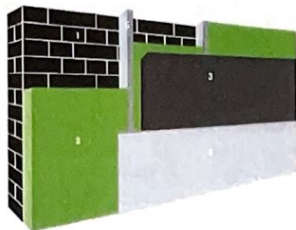
1. Buitenmuur | 2. Isolatie | 3. Vochtscherm | 4. Afwerkingslaag | 5. Stijl- en regelwerk (optioneel)
