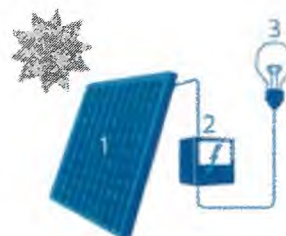
1. Zonnepaneel | 2. Omvormer | 3. Elektrische toestellen
