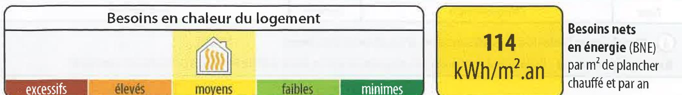
Ces besoins sont les apports de chaleur à fournir par le chauffage pour maintenir constante la température intérieure du logement. Ils dépendent des pertes par les parois selon leur niveau d'isolation thermique, des pertes par manque l'étanchéité à l'air, des pertes par la ventilation mais aussi des apports solaires et des apports internes.
