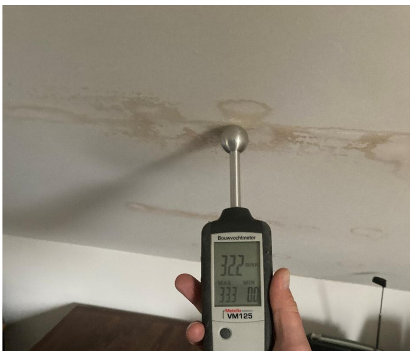
Photo n°9 : local dénommé bureau sur le plan Observation : brunissement de paroi sur toiture inclinée Mesure d'humidité absolue de 32,2 sur une échelle de 100,0
