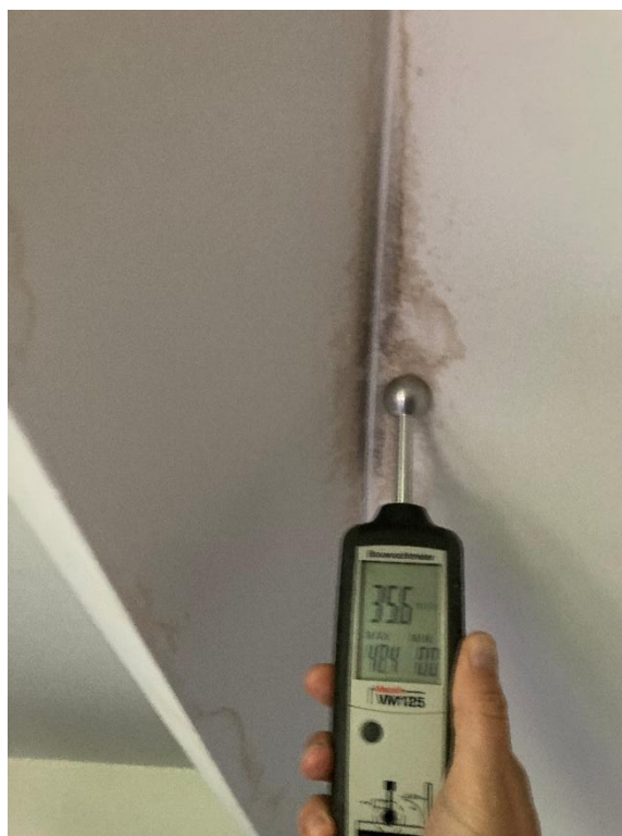
Photo n°10: local dénommé bureau sur le plan Observation : brunissement de paroi sur toiture inclinée Mesure d'humidité absolue de 35,6 sur une échelle de 100,0
