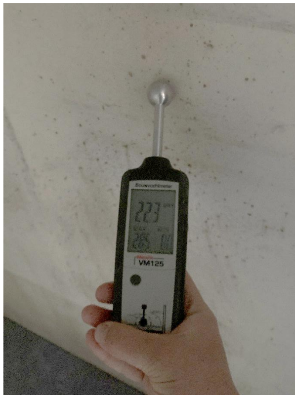
Photo n°5 : local dénommé grenier sur le plan (façade orientée NO) Mesure d'humidité de 22,3 sur une échelle de 100,0
