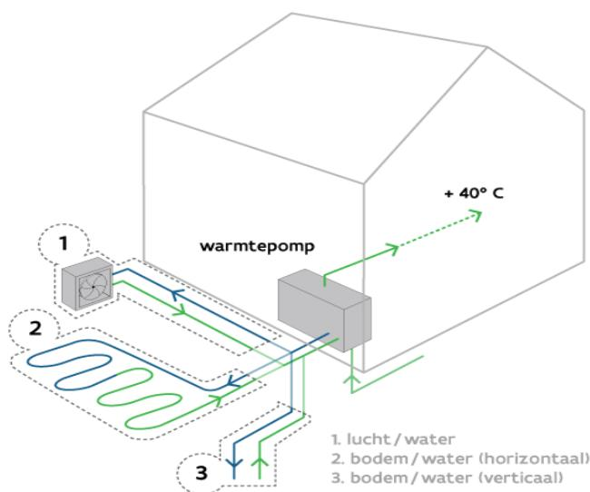
Als uw woning al goed geïsoleerd is en als u beschikt over oppervlakteverwarming of voldoende grote radiatoren, dan kunt u de plaatsing van een warmtepomp overwegen. Bij uw renovatie kunt u het best kiezen voor een systeem met een seisoensprestatiefactor (SPF) van 4 of hoger.
