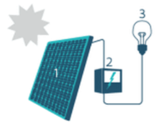
1. Zonnepaneel | 2. Omvormer | 3. Elektrische toestellen
