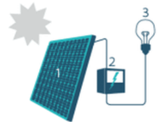
1. Zonnepaneel | 2. Omvormer | 3. Elektrische toestellen
