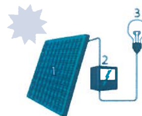
1. Zonnepaneel | 2. Omvormer 3. Elektrische toestellen
