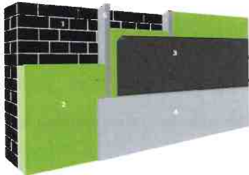
1. Buitenmuur | 2. Isolatie | 3. Vochtscherm | 4. Afwerkingslaag | 5. Stijl- en regelwerk (optioneel)
