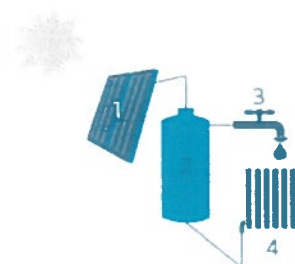
Fig. 2: Zonneboiler om warm water te produceren
