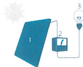
Fig. 1: Zonnepanelen (PV) om elektriciteit te produceren
