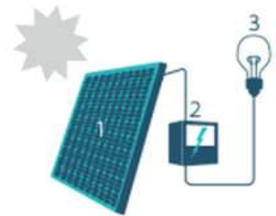
1. Zonnepaneel | 2. Omvormer | 3. Elektrische toestellen
