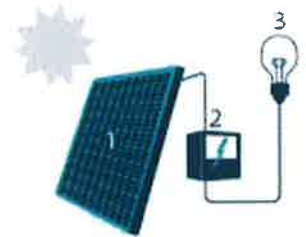
1. Zonnepaneel | 2. Omvormer | 3. Elektrische toestellen
