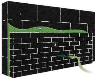
1. Dragende muur | 2. Ingeblazen isolatie | 3. Gevelsteen / gevelbekleding
