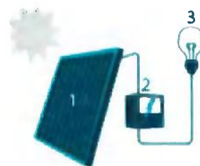
1. Zonnepaneel | 2. Omvormer | 3. Elektrische toestellen
