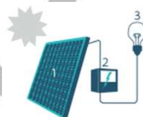
1. Zonnepaneel | 2. Omvormer | 3. Elektrische toestellen
