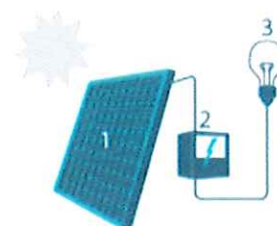
1. Zonnepaneel | 2. Omvormer | 3. Elektrische toestellen
