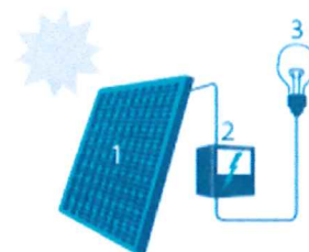
1. Zonnepaneel | 2. Omvormer | 3. Elektrische toestellen
