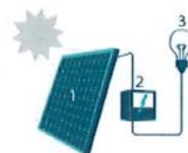
1. Zonnepaneel | 2. Omvormer 3. Elektrische toestellen
