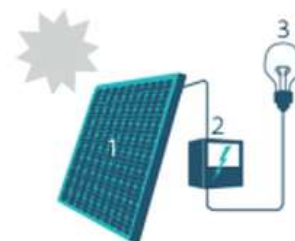
1. Zonnepaneel | 2. Omvormer | 3. Elektrische toestellen
