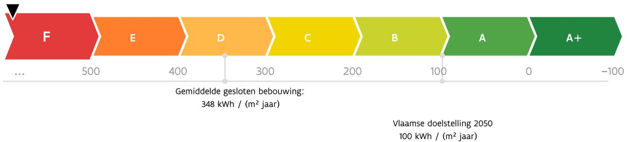
De energiescore en het energielabel van deze woning zijn bepaald via een theoretische berekening op basis van de bestaande toestand van het gebouw. Er wordt geen rekening gehouden met het gedrag en het werkelijke energieverbruik van de (vorige) bewoners. Hoe lager de energiescore, hoe beter.
