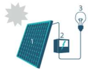
1. Zonnepaneel | 2. Omvormer | 3. Elektrische toestellen
