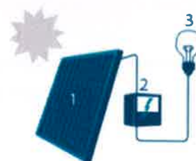
1 Zonnepaneel 2 Omvormer 3 Elektrisch (lichtpunt)
