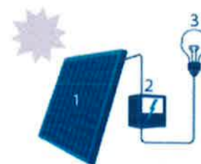
1. Zonnepaneel | 2. Omvormer 3. Elektrische toestellen
